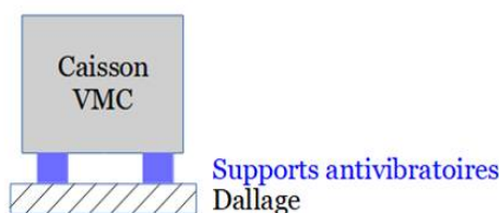
Exemple de disposition d'un caisson de ventilation avec supports anti vibratoires.
